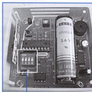
б) Плата датчика с радиосвязью
